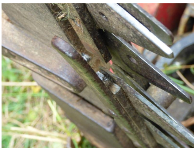
Illustration 12: Rupture de la lame sans doute liée à un défaut dans la masse de l'acier
