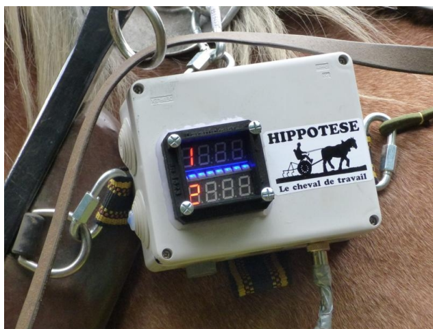
Illustration 8: Boîtier master et son double affichage numérique
