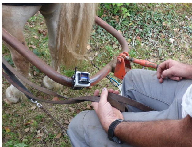
Illustration 11: Le bracelet du récepteur du dataficheur est parfaitement adapté à la forme cylindrique des brancards. La lecture est facile pour le meneur.
